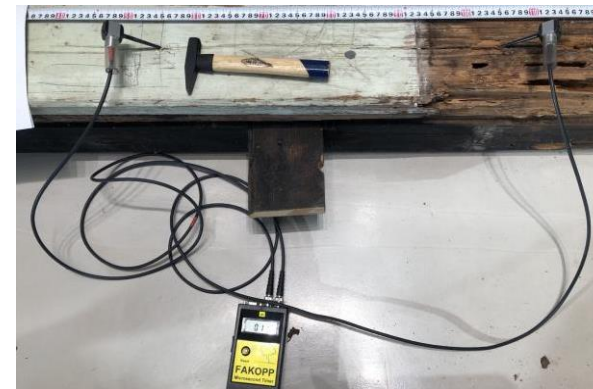
最新の弾性波準非破壊検査 50cm間隔で計測
