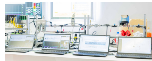
ガス供給模擬プラントと監視画面
