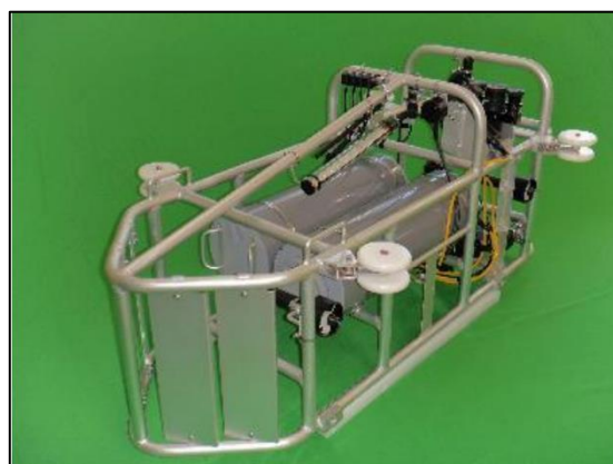
図 3-6 浮体式水面ドローン 51
