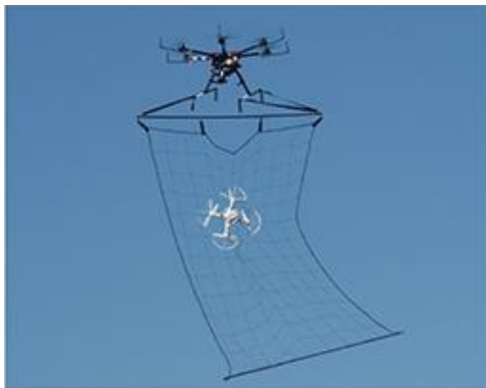
図 4-6 小型無人機を捕獲する「迎撃ドローン」 79
