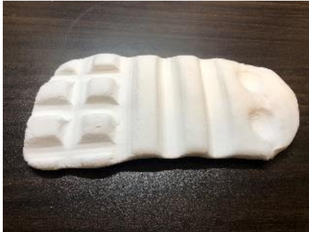
図 7 : 紙粘土で作成した位相記録板 図 8 : 紙で作成している様子
