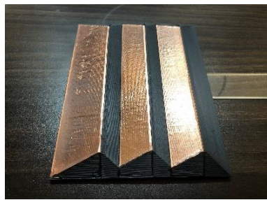
図 6: 3D プリンタで作成した位相記録板
