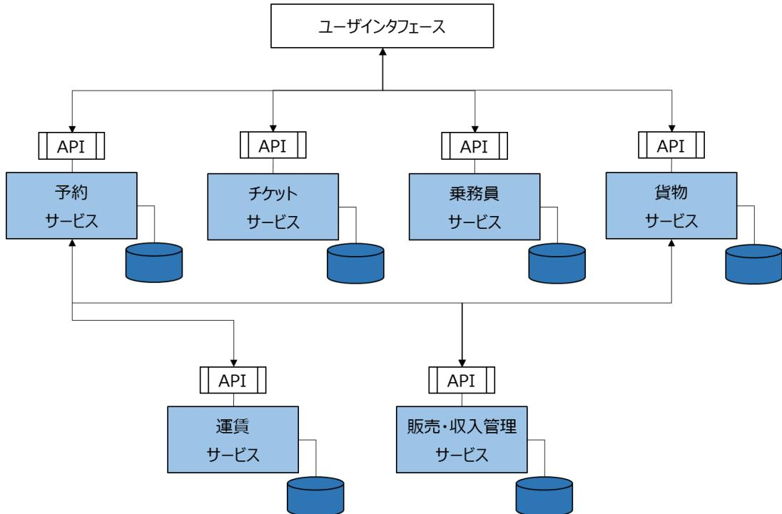
図 4.3.2 マイクロサービスの構成例
