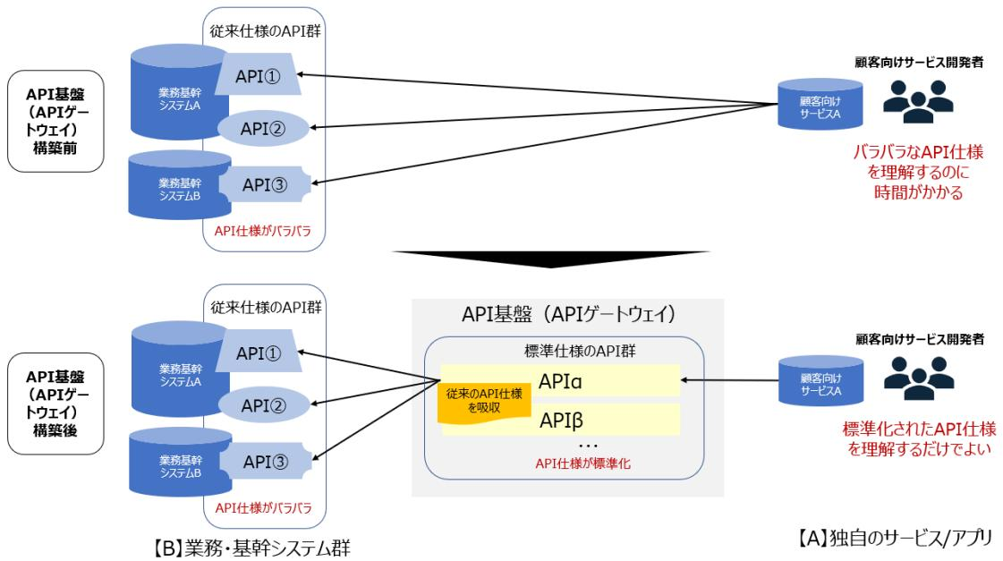
図 4.5.8 API 基盤構築前後の比較
