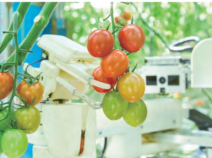
AI技術の産業応用例。パナソニックのロボット収穫機は、AIを導入したことによって、トマトの認識率が大幅に向上した。 提供：パナソニック
