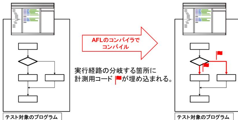
図 1 AFL による計測用コードの挿入
