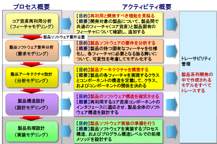
図 92-20 製品系列開発プロセスのアクティビティ
