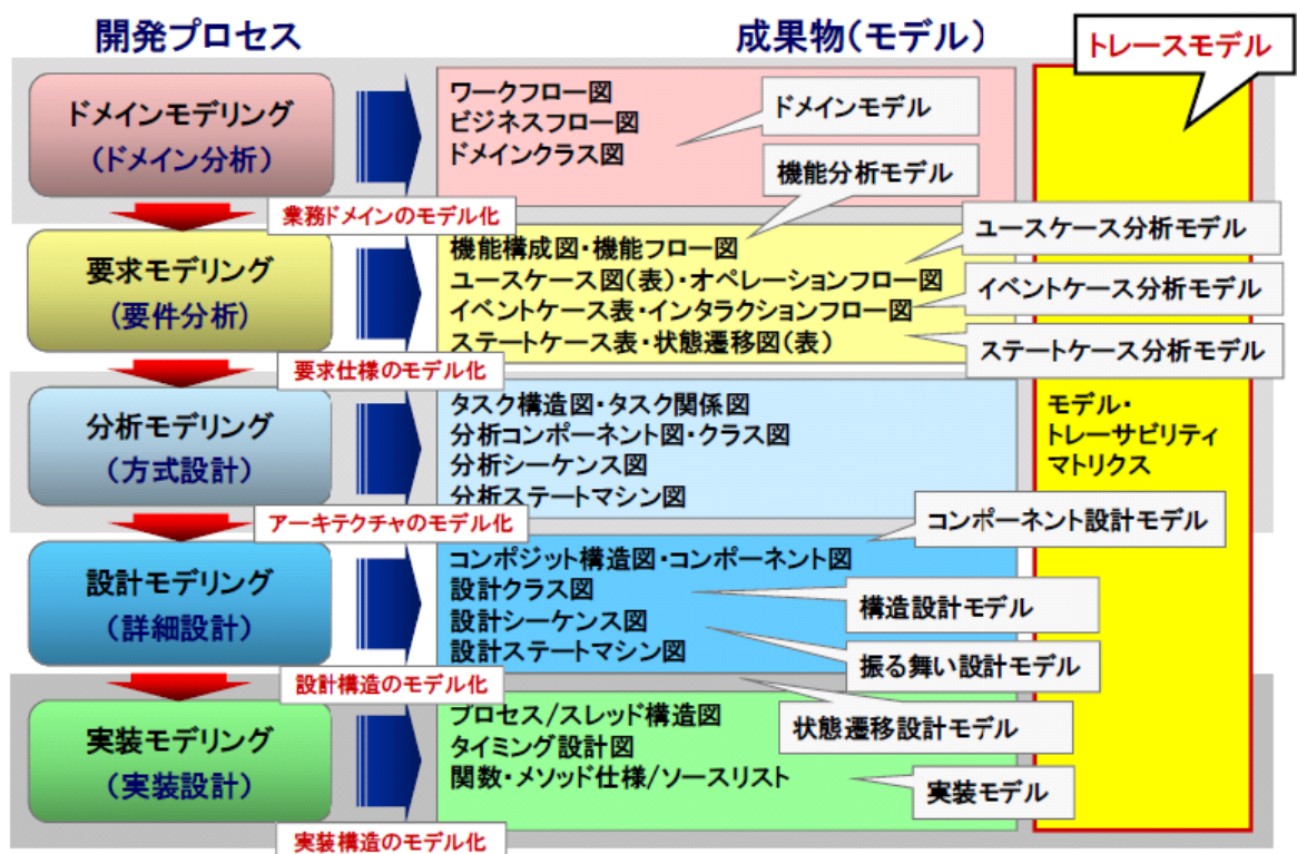
図 81-5 モデル指向開発の開発プロセスと成果物
