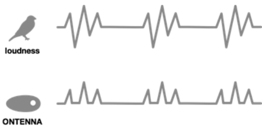
図 6 音圧の変化をリアルタイムに振動に変換
