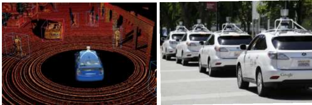
図表 4: LIDAR が取り付けられた Google 社の自動運転車
