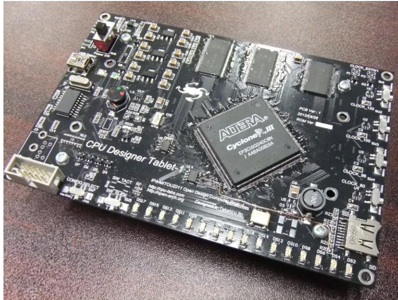
図 3 開発した MIST32 ターゲット FPGA ボード
