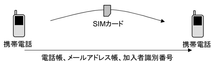
図 A-9 携帯電話間の SIM カードの移動
