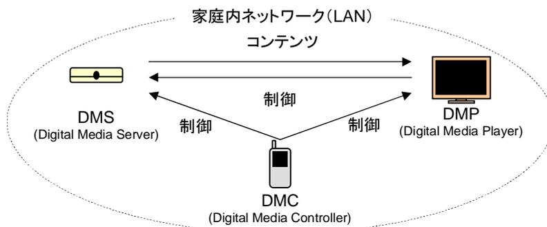
図 A-19 家庭内ネットワーク内で携帯電話を DLNA の DMC (Digital Media Controller) として利用
