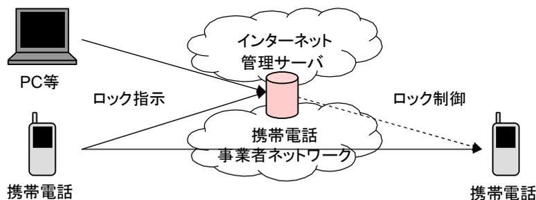
図 A-15 携帯電話の遠隔ロック
