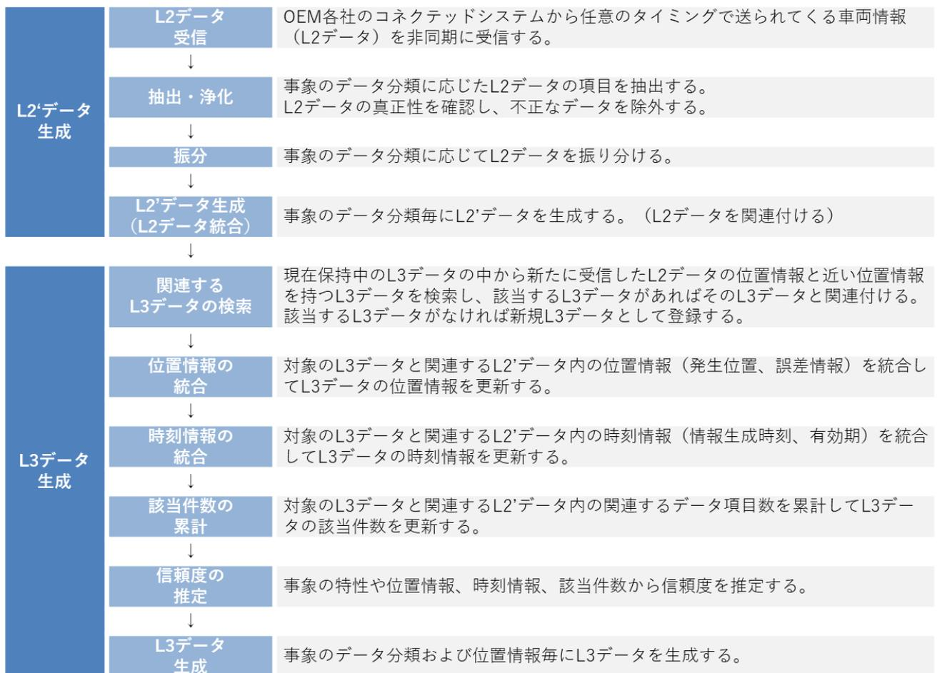
図 22 車両情報連携システムのデータフロー（詳細）
