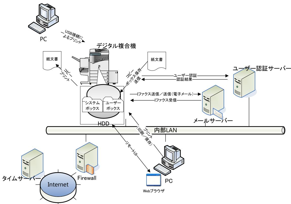
Figure 1 に示すような想定設置環境では、デジタル複合機は内部 LAN によってメールサーバー、ユーザー認証サーバー、PC、Firewall に接続されており、Firewall によって Internet から内部 LAN への攻撃を防いでいる。デジタル複合機は、自身で読み込んだ電子文書を I ファクス送信や電子メール送信したり、I ファクスを受信したりするためにメールサーバーに接続する。また、PC を用いて電子文書をプリント、
