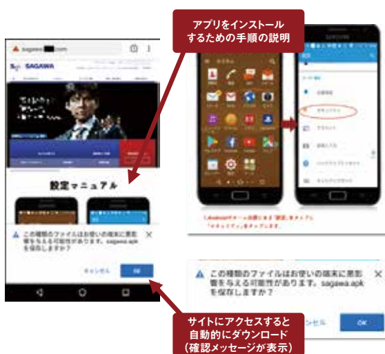
■ 図 3-3-2 Android 端末で偽サイトにアクセスした場合の画面例（出典）IPA「安心相談窓口だより」宅配便業者をかたる偽ショートメッセージに関する新たな手口が出現し、iPhone も標的に *156 」
