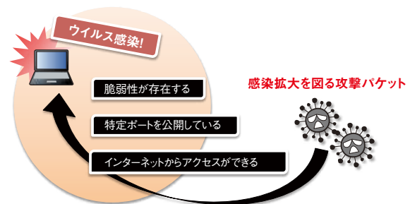
■ 図 1-3-1 Wanna Cryptor に感染してしまう三つの環境要因 (出典)IPA「WannaCryptorの相談事例から学ぶ一般利用者が注意すべきセキュリティ環境 *115 」
