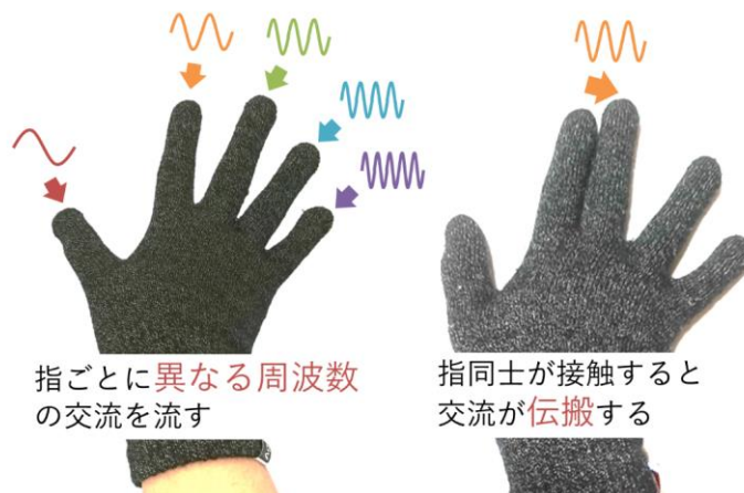
図 4. 指同士の接触検出の原理
