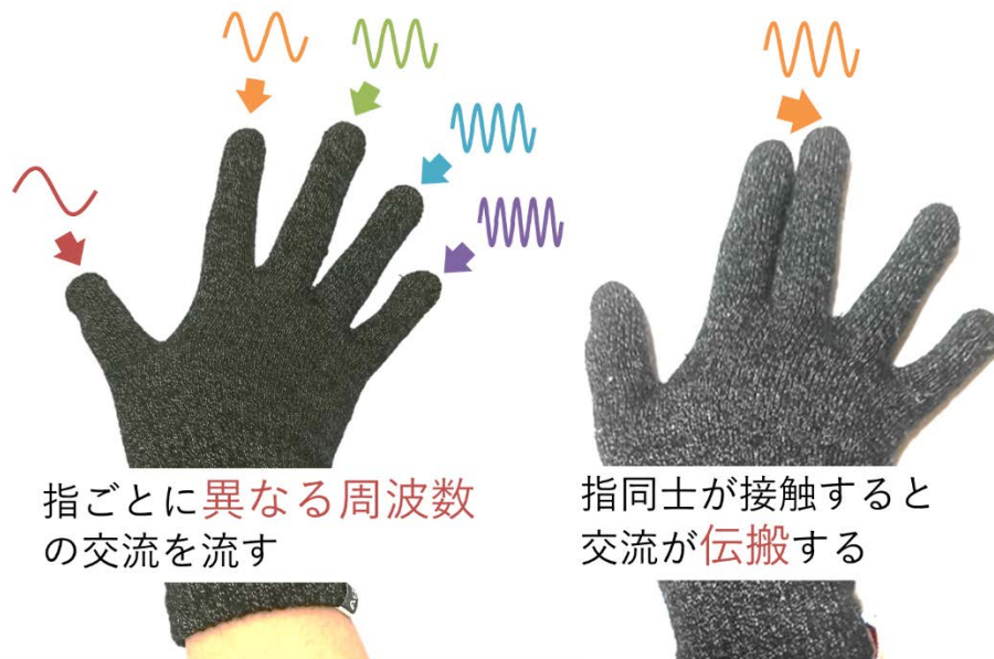
図 4 指同士の接触検出の原理
