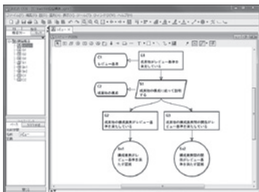
図3 GSNの例 品質の妥当性を説明するGSN。C (前提)に基づいてG (ゴール)をS (戦略)でサブゴールに分割し、末端にSn (解決)を付けて説明する。
