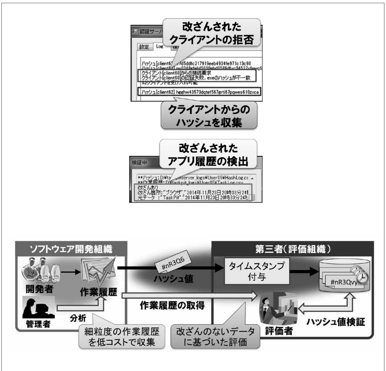
図9 システムの画面表示例、および、同システムが実現するソフトウェア開発組織と第三者(評価組織)との関係
