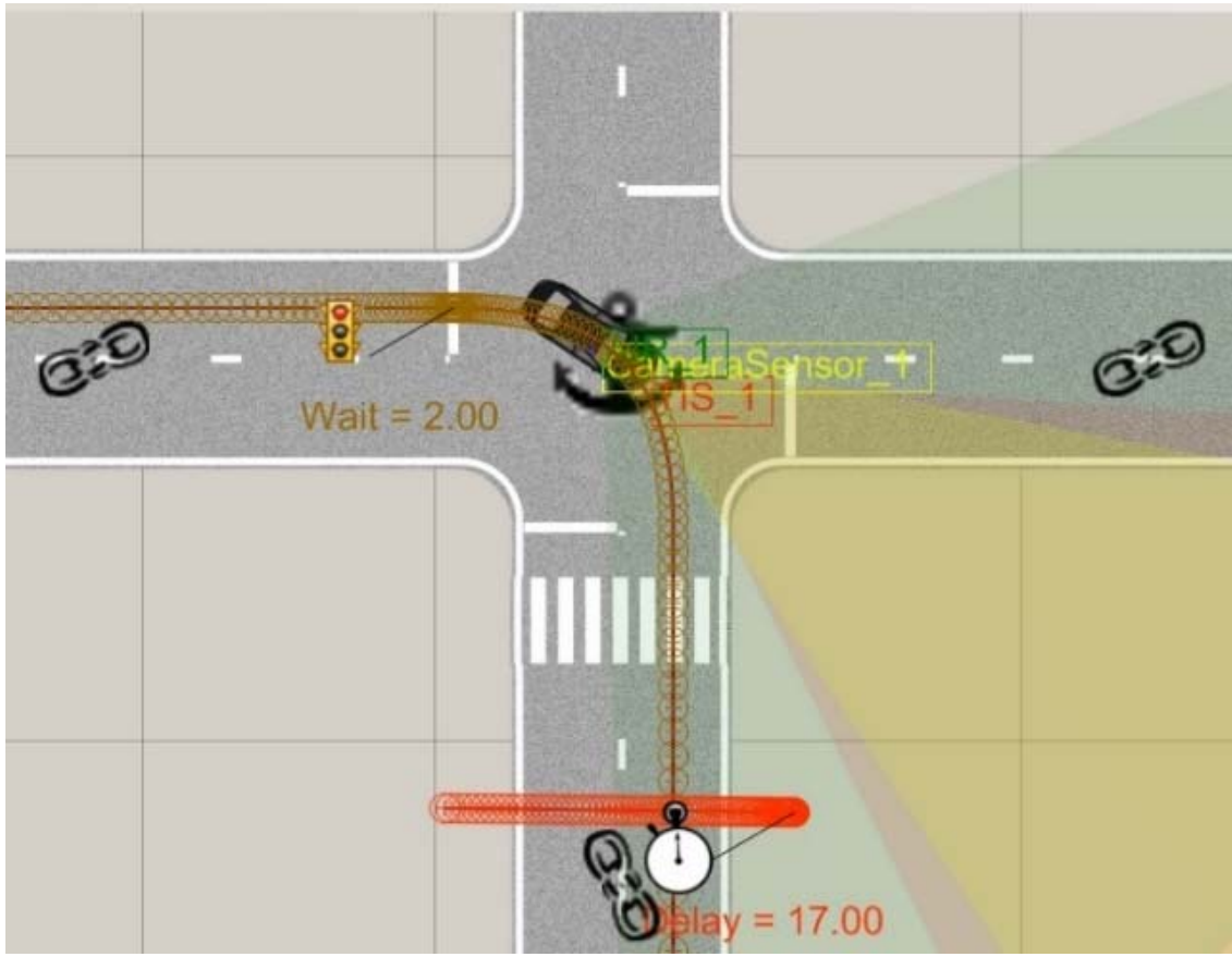
図 3-3-17 PreScan で構築した自動運転での右折時，自動運転システムによる緊急停止または，ドライバの介入によるオーバーライドに関するモデル
