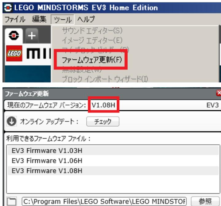
EV3 と USB 接続が成功している場合、このウィンドウ上部に現在インストールされている EV3 ファームウェアのバージョンが表示される。このバージョンが 1.08H 以外である場合(1.09H 以降含む)、アップデートが必要となる。1.08H の場合はアップデート不要のため、「ロボットと PC との接続」まで読み飛ばしていただきたい。EV3 ファームウェアは LEGO 社ホームページ<sup>1</sup>からダウンロードする。この状態で、下部の「ダウンロード」をクリックすると、EV3 へのファームウェアのダウンロードが始まる。
