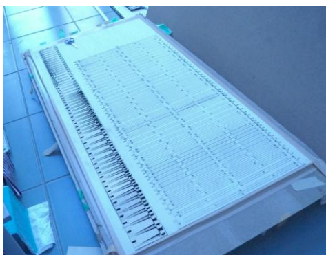
図 6 レーザーカットされた合板
