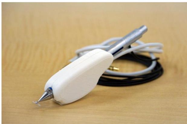
図 2 触感の I/O デバイス
