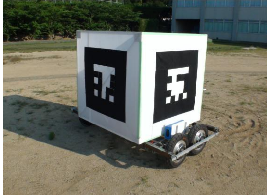
図 1 ライン引きのためのロボット「フィールドペインター」
