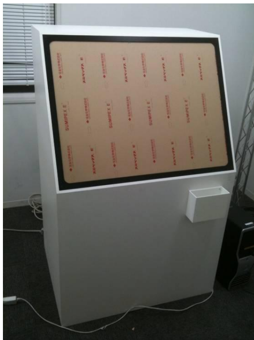
図9:作成した展示用筐体。寸法はW900×D700×H1400(mm)程度で、スクリーンサイズは約40インチ。内部に立体映像提示用のプロジェクタ、PC等を配置可能。
