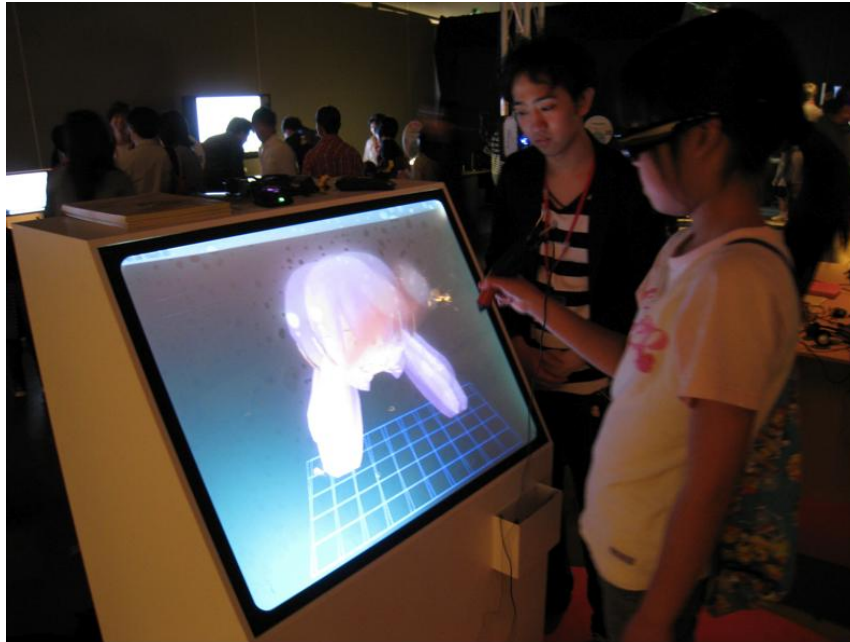
図 10: 立体映像との触覚インタラクションシステム。空中に浮かんだ立体映像を Pen de Touch デバイスで触って動かしたり、形を確認したりすることができる。
