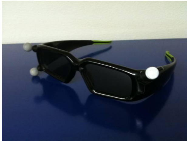
図 11: マーカを配置した 3D 眼鏡 (nVidia 3D Vision)
