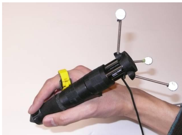
図 2: ペン先部にボタンを配置した Pen de Touch デバイス
