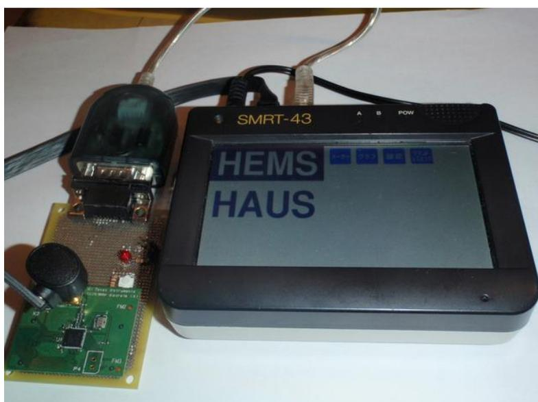
図4:ホームエネルギー管理システムとネットワーク(ZigBee)モジュール
