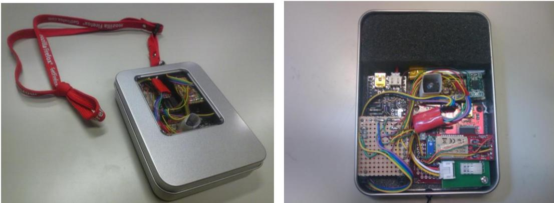
図 3 センシングアクセサリの内部構造
