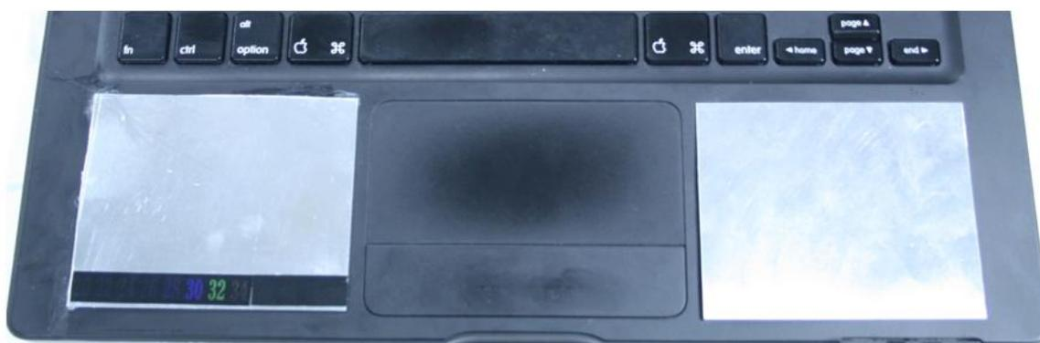
図 4 AffectiveChat 用の改造したパームレスト(ペルチエ素子が載せてある)
