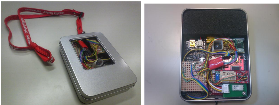
図 3 センシングアクセサリの内部構造
