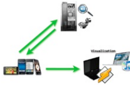
図4. 開発したシステムのモデル図. 写真と環境音声を iPhone3G/3GS 上でキャプチャーし, 環境音声のみを CASA サーバに送信. そして, サーバの解析結果を iPhone 側に送り返し, iPhone 上でタグを登録する.
