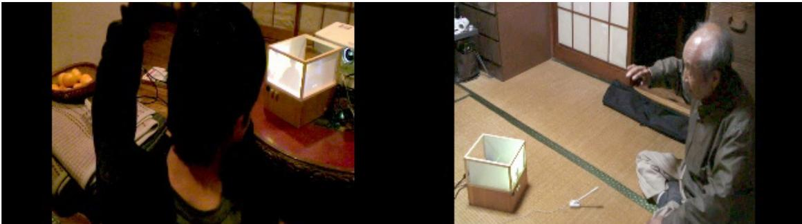
未踏ユース応募前の影電話のプロトタイプは、「IP 電話の子機の別の形」として実装されていた。USB カメラと小型プロジェクタとタッチパネルとターンテーブル(とその制御の電子回路)を内部に組み込んだ行灯を2台作成してあった。影にタッチすると、相手に Skype API でコールし、音声通話ができる。しかし、その動作は LAN の中に限られており、画質は荒く、インタフェースの操作性とソフトウェアの安定性がまだまだプロトタイプレベルなので、影電話が本当に距離に隔てられたプライベートスペース同士を繋いで同じ空間にいるようなコミュニケーションを実現する行灯かどうか？を、プロトタイプを用いたコンセプトムービー以上のレベルでは確認することができなかった。
