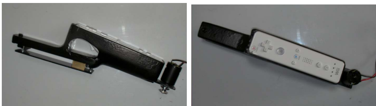
図3. 4 Wii リモコン用フォースフィードバック機構
