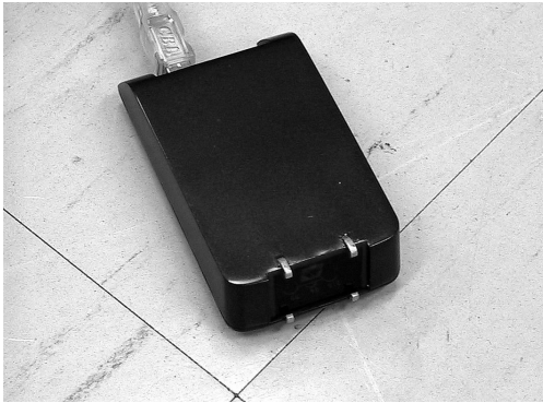
図5：通信デバイス（汎用リモコン。エージェントと家電などとの通信に利用している。制御対象の識別信号を受け、それに対応した制御信号を発信する。）
