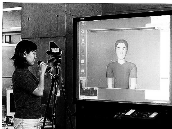
図1：人間型ソフトウェアロボットのプロトタイプと人間の対話の様子
