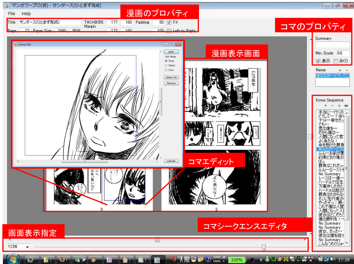
図 1. ソフトウェア実行画面。コマエディットにおいては Microsoft.Ink API によるペンツールでの描画と、絵のフレーミングの指定が可能。フレーミングの指定及びその他プロパティを変更することで、いつでも動的にコマ割編集が可能となっている。
