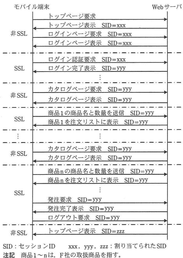
図 2 モバイル端末と Web サーバ間の送受信シーケンス
