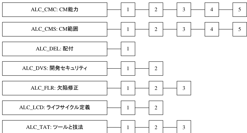
図 13 ALC: ライフサイクルサポートクラスのコンポーネント構成
