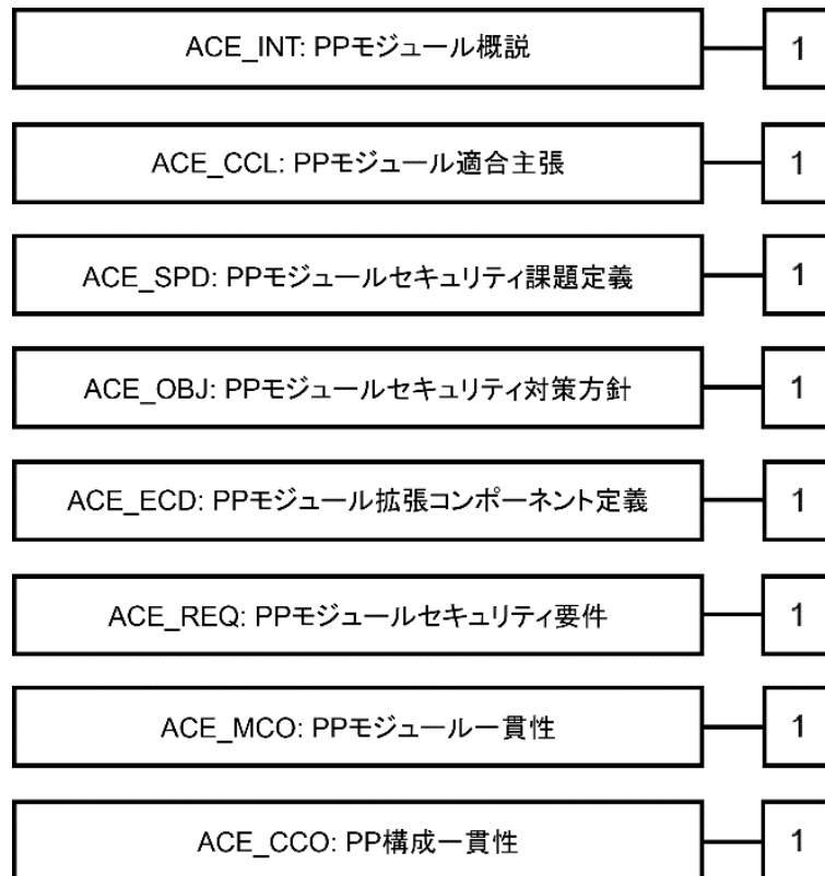
図 9 - ACE: プロテクションプロファイル構成評価クラスのコンポーネント構成
