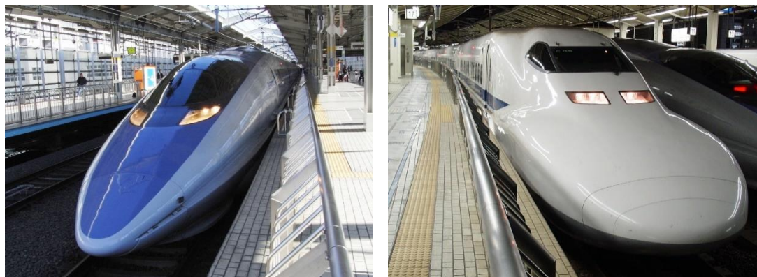
新幹線の「鼻」は空気力学とすり合わせでつくられる。
