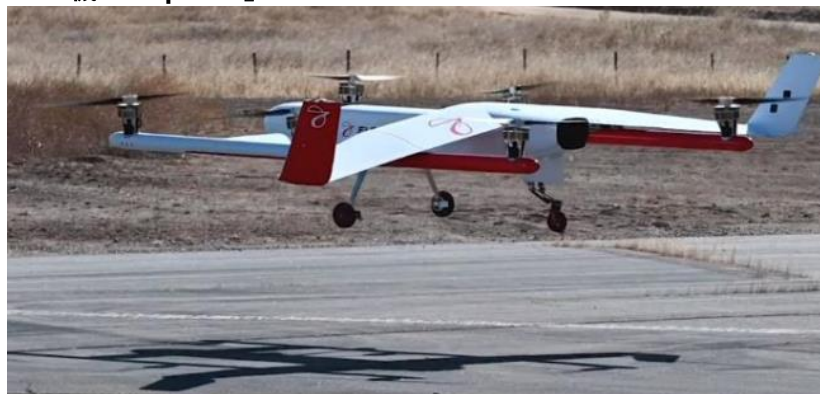
図表 15:2019 年 8 月に初飛行に成功した 100~225kg の重量の貨物を約 500km 先まで運べる Elroy Air 社の自律型 VTOL 機「Chaparral」
