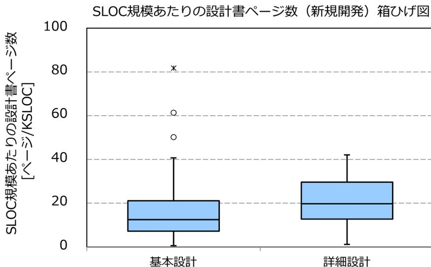
図 A1-3-1 SLOC 規模あたりの設計書ページ数(新規開発)の箱ひげ図
