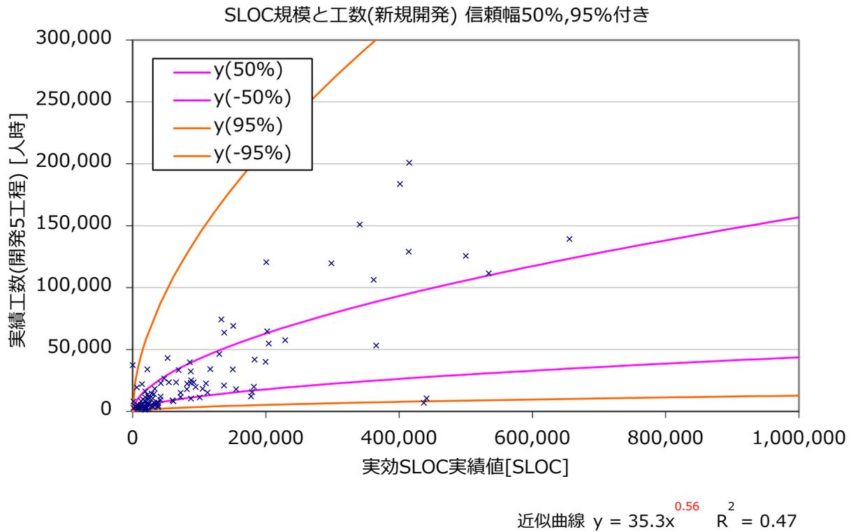
図 A1-1-2 SLOC 規模と工数(新規開発)
