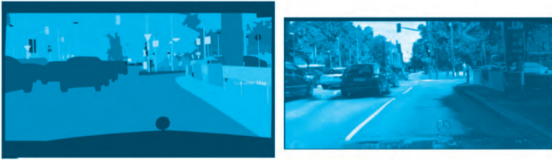
■ 図3 NVIDIAによる、領域指定画像(左)とそれにもとづく自動生成写真(右)
