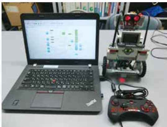
図 2.2-3 二輪倒立ロボット、遠隔操作装置、遠隔制御 (Simulink) の外観
