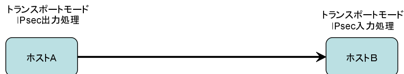
図 3.7: ホスト間のトランスポートモード IPsec 通信 ([99] をもとに作成)
