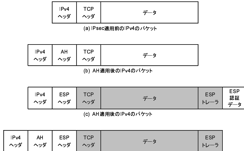
図 3.9: IPsec による IP データグラムのカプセル化 (IPv4)(出所 : [99])
