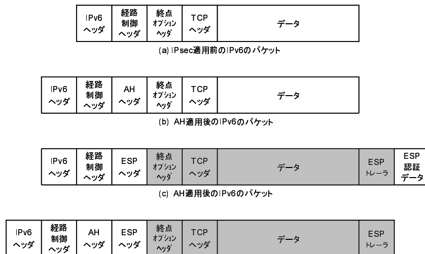
図 3.10: IPsec による IP データグラムのカプセル化 (IPv6)(出所 : [99])
