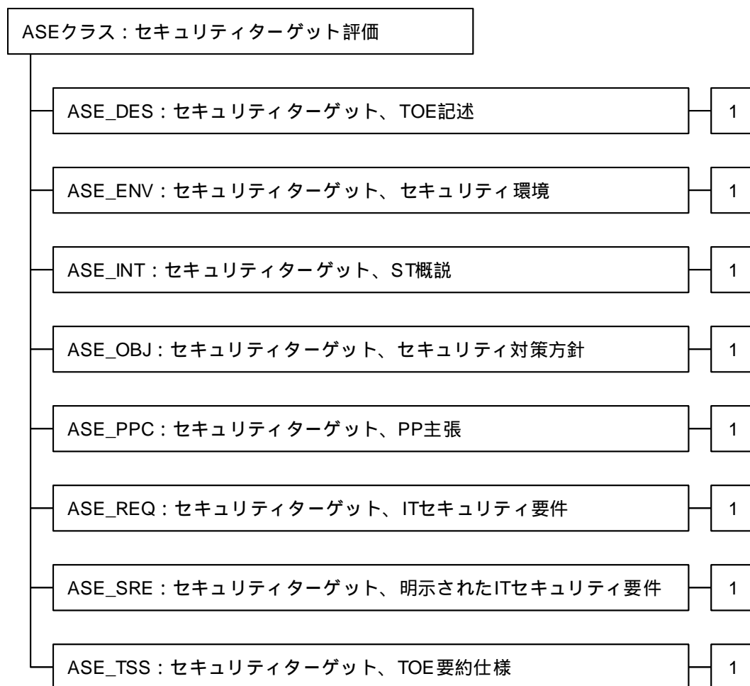
図 5.1 - セキュリティターゲット評価クラスのコンポーネント構成
