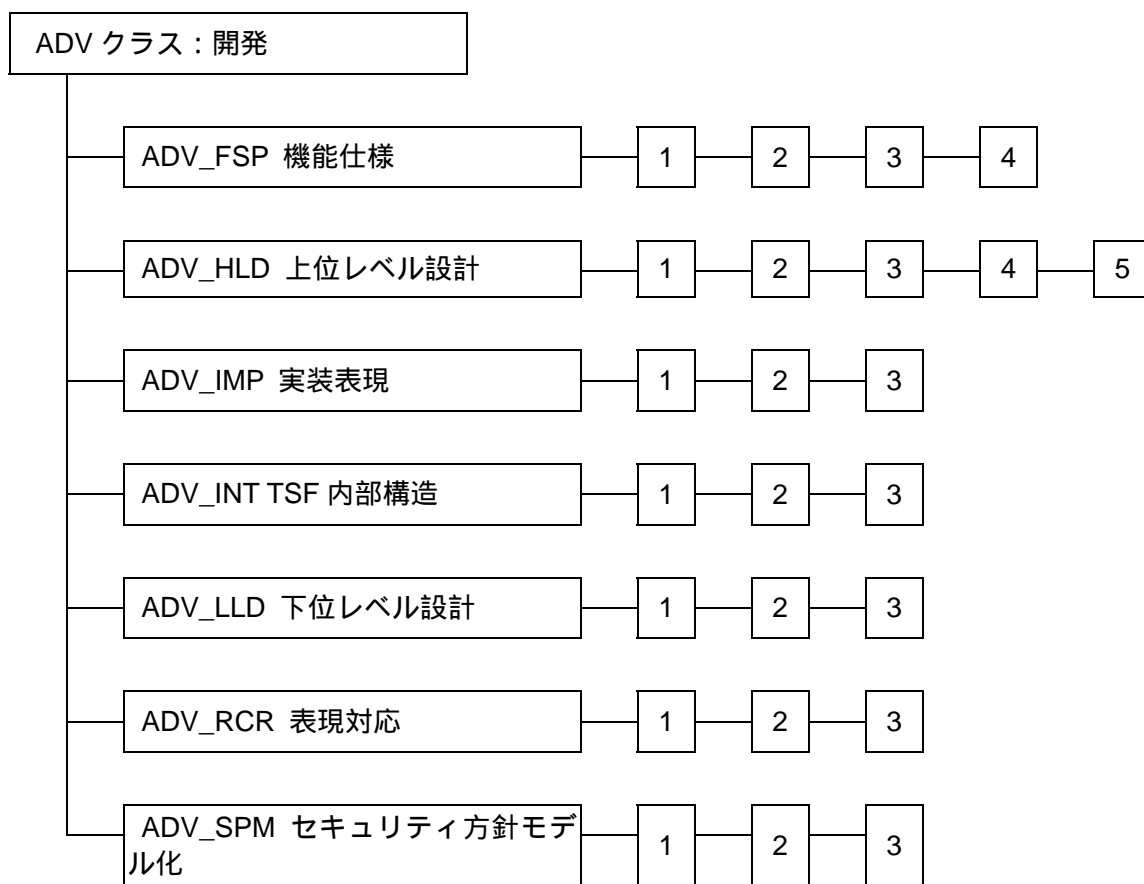
図 10.1 - 開発クラスのコンポーネント構成
