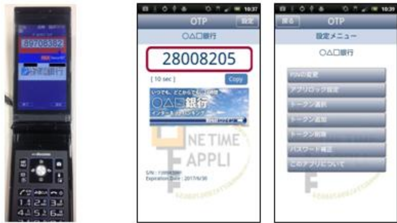
図 7：従来型携帯電話やスマートフォンのソフトウェア（アプリ）トークンによるワンタイムパスワード生成器
