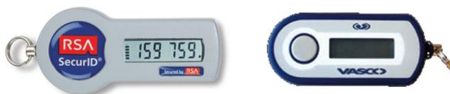
図6：ハードウェアトークンによるワンタイムパスワード生成器
