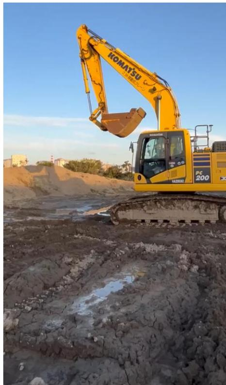
従来のマシンガイダンスアプリケーションは、建設機械がいる場所の施工基準面（地盤高）を表示し、建設機械の挙動を可視化するが、地下埋設物の情報などは表示できない。
