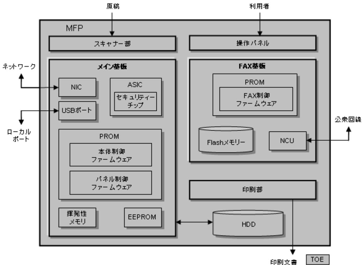
図 1.2 TOE の物理的構成図
